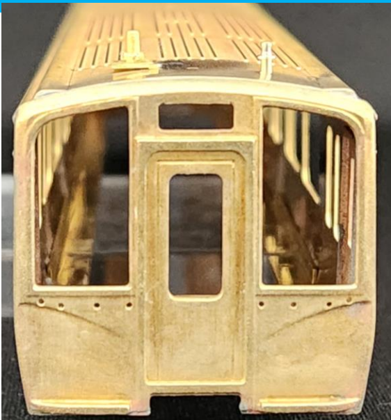
列車無線アンテナ・信号煙管ハンダ付完了!
