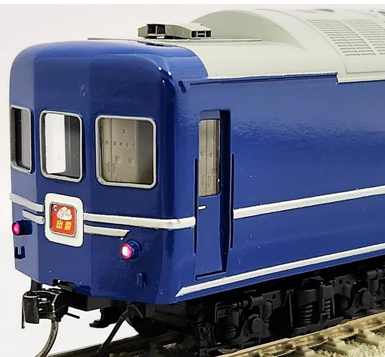
カニ24 ロスト製の「連結器胸受け」を取付けて完成です
