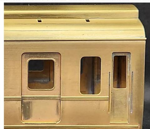
エンジン排気口、屋根換気口もロスト部品を裏からハンダ付け
