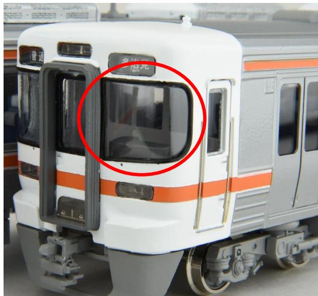
今回1・2次車の特徴として、前面の窓枠が前回製品(3次車)より「太く」なります
